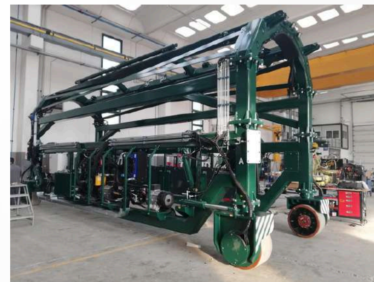
Macchina Full electric per trasporto tubazioni in galleria
